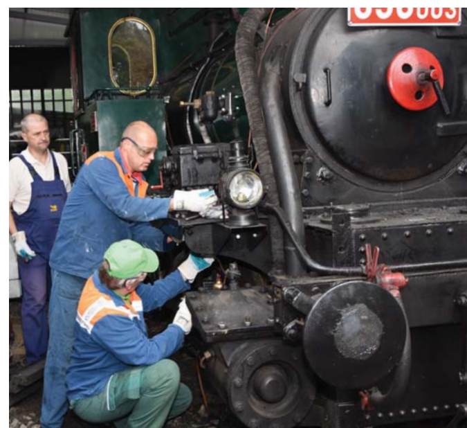
Zlomený posúvač na parnom valci na lokomotíve Katka opravovali (zľava doprava) Luboš Nežník , Eduard Kandík a Pavol Petráš .
