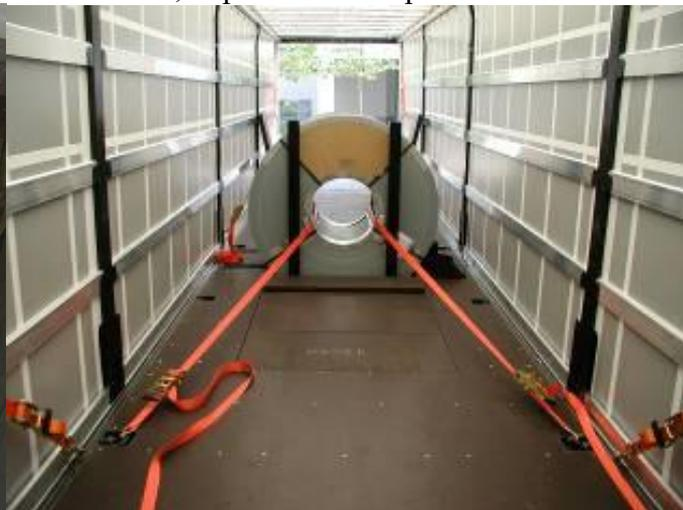
*Uviazanie stabilného zvitku blokováného klanicami pevnejšími popruhmi do pevnejších viazacích bodov proti pohybu dozadu*
